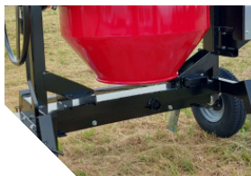
Renforts châssis avec prises fourreaux incorporés.
