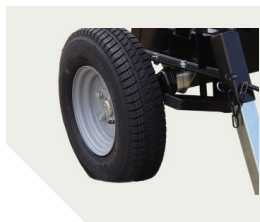
Roues 500 x 10 et pédale en fer-plat permettant une bonne prise au pied.
