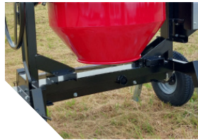
Renforts châssis avec prises fourreaux incorporés.
